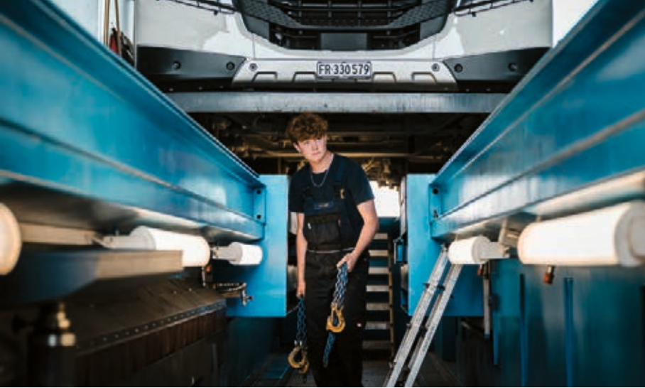
◀ Loïc Longet hängt Ketten an die Achse, um verschiedene Belastungen zu simulieren.
