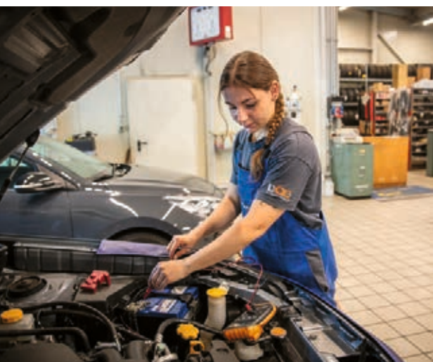
↗ Mit dem Multimeter misst Sina Delli Bovi die elektrische Spannung.
